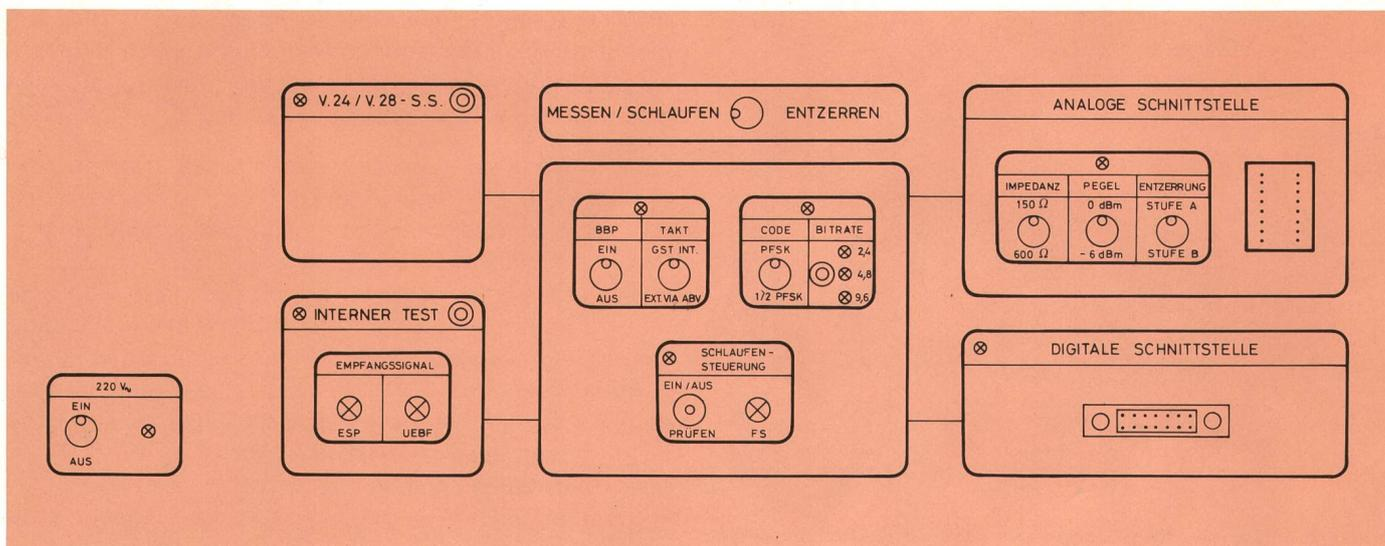
Fig. 11 Frontansicht des Schlaufentest- und Prüfgerätes GST – Vue frontale de l'équipement de mise en boucle et de test GST
