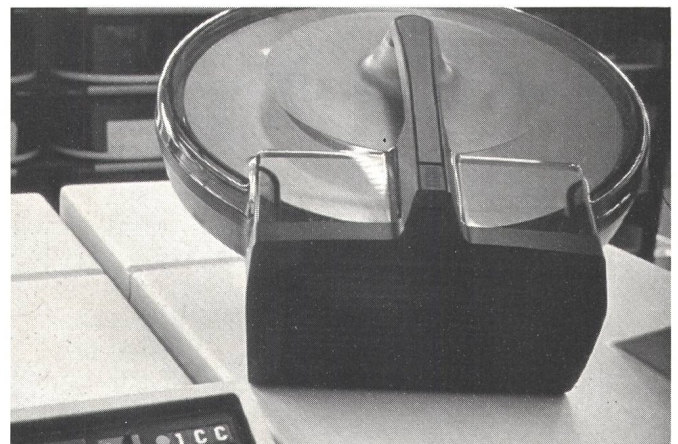
Fig. 6 Plattenspeicher im Terco-Zentrum Meggen. Neun solche Speicher enthalten die Daten für die 18 Telefonbücher. Die Daten fanden auf einem Teil dieser Speicherkapazität Platz. Des schnelleren Zugriffs wegen sind die Angaben jedoch auf neun Speicher aufgeteilt — Mémoires à disques du centre Terco de Meggen. Neuf de ces disques contiennent les données des annuaires téléphoniques. En fait, les données n'occuperaient qu'une partie de cette capacité de mémorisation, mais la répartition sur neuf disques permet d'accéder plus rapidement à l'information
