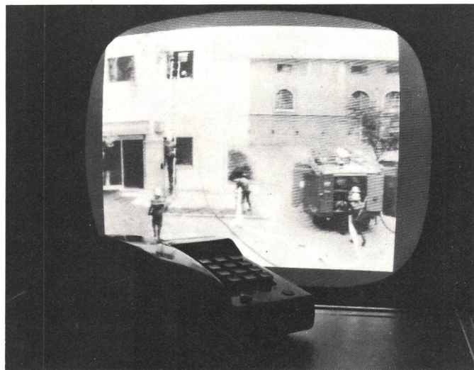
Fig. 2 Bewegungsbildübertragung mit reduzierter Auflösung über normale Telefonleitung mit 9,6 kbit/s
