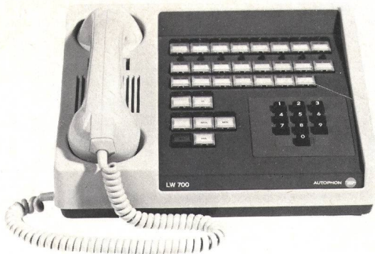
Fig. 8 Linienwählerapparat am Beispiel des Typs A8/15 mit Impulswahl- statur. Der Apparat ist im PTT-Universalgehäuse UG 33 T1 eingebaut. Als Tasten sind Siemens-Printtasten eingesetzt — Sélecteur de lignes à l'exemple du type A8/15 avec clavier de sélection par impulsions. L'appareil est monté dans le boîtier universel PTT UG 33 T1. Les tou- ches sont du type pour circuit imprimé de Siemens
