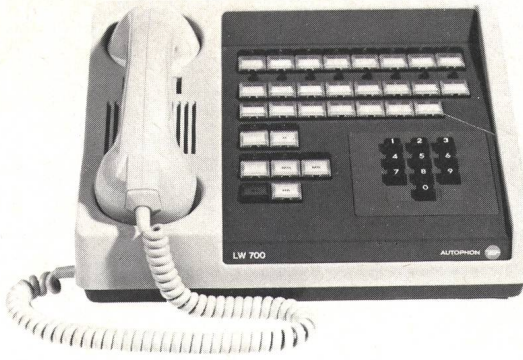
Fig. 8 Linienwählerapparat am Beispiel des Typs A8/15 mit Impulswahl- statur. Der Apparat ist im PTT-Universalgehäuse UG 33 T1 eingebaut. Als Tasten sind Siemens-Printtasten eingesetzt — Sélecteur de lignes à l'exemple du type A8/15 avec clavier de sélection par impulsions. L'appareil est monté dans le boîtier universel PTT UG 33 T1. Les tou- ches sont du type pour circuit imprimé de Siemens
