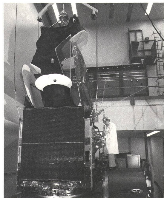
Fig. 2 Intelsat V mit gefalteten Solarflügeln und zugeklappten Antennenreflektoren — Intelsat V avec panneaux de cellules solaires repliés et réflecteurs d'antennes rabattus
