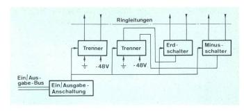
Fig. 9 Struktur eines Ein-/Ausgabe-Rahmens
