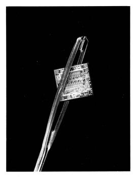
Environ 25 000 fonctions logiques sont contenues sur la surface de 4,4 mm  $\times$  5,3 mm de ce microprocesseur — This microprocessor contains about 25 000 logical functions in an area of 4.4 mm  $\times$  5.3 mm
