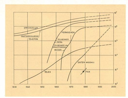
Développement des moyens de télécommunication en Suisse Graphs showing the development of telecommunications in Switzerland Téléphone - Telephone Postes de conversation -Telephone sets Raccordements principaux - Exchange lines Télévision - Television Nombre total d'abonnés Total number of sets Abonnés raccordés à la télévision par câbles - CATV subscribers Données (modems) - Data (mo-
