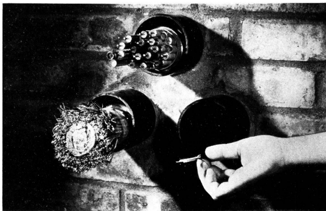
Une seule fibre de verre (à droite en bas) permet de transmettre au moins autant de conversations que des câbles ordinaires à plusieurs paires de conducteurs ou des câbles coaxiaux (à gauche, en bas et en haut) — With a single optical fibre (below right) at least as many telephone calls can be established as with ordinary multiwires or coaxial cables (below and above left)
