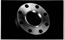
Reinstgold ist ein idealer Werkstoff für den Einsatz in metallgedichteten Apparaturen. Die 50 µm dicke Goldschicht wird nur an der funktionellen Stelle (im Bild als heller Streifen erkennbar) aufgebracht. Die spezielle Werkstoffpaarung – der Ventilteller besteht aus Saphir, der Ventilsitz wird durch die reinstvergoldete Edelstahlkante gebildet – gestattet, Ventile dieser Art auch bei erhöhten Temperaturen für korrosive Gase einzusetzen und erlaubt eine Ausheizbarkeit bis zu 450°C.
