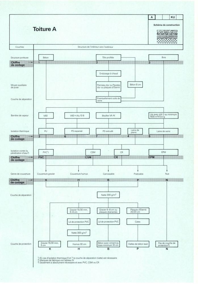
Annexe II Feuille schématique pour la construction de toits type A (isolation contre la pénétration d'eau avec KU)
