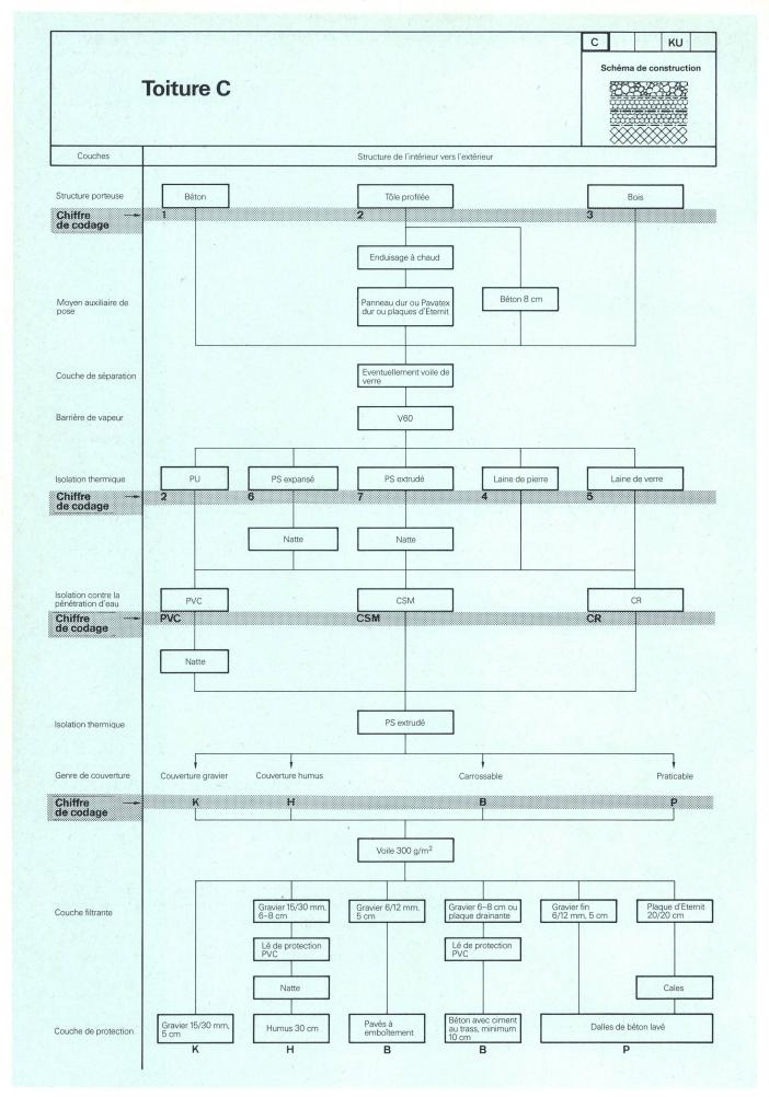
Annexe V Feuille schématique pour la construction de toits type C (isolation contre la pénétration d'eau avec KU)
