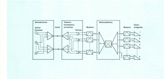
Fig. 1 Datennetz auf der Basis des Telefonwählnetzes Normalfall: Totale Zahl Endgeräte n≥ Anzahl Pforten m (Zahl der aktiven Endgeräte p≤m)
