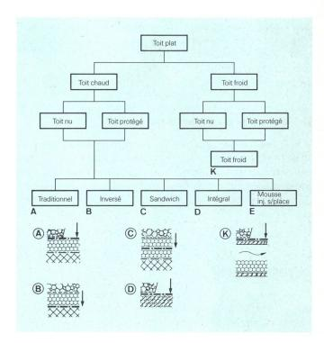
Fig. 2 Les différents éléments du toit plat
