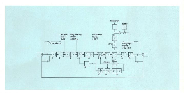
Fig. 7 Blockschema des digitalen Zwischenverstärkers
