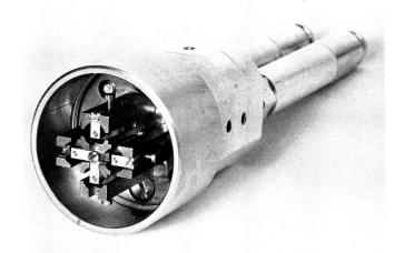
Fig. 4 Doppelt polarisierter 4-GHz-Strahler. Von links nach rechts: Schlitz-übertrager im Rundhohlleiterstück, zweifacher Leistungsteiler, Impedanztransformatoren 25/50  $\Omega$ , Kabelanschlussstücke für SR7
