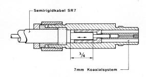
Fig. 5 Kompensiertes Kabelanschlussstück für Semirigidkabel SR7
