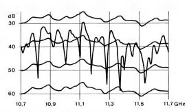
Sender 1,1m ø Antenne vertikal, Empänger 4,28m ø Antenne horizontal polarisiert
