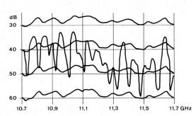
Sender 1,1mø Antenne horizontal, Empfänger 4,28mø Antenne vertikal polarisiert
