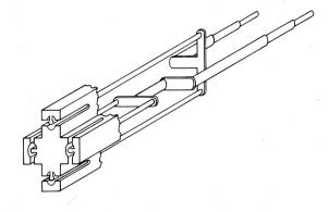
Fig. 3 Innerer Aufbau des koaxialen, zweifachen Leistungsteilers
