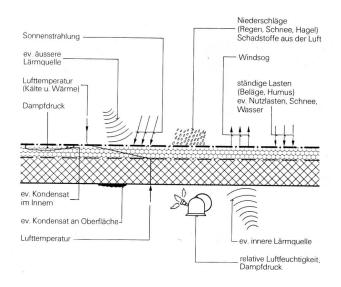
Fig. 1 Klimatische und bauphysikalische Einflüsse auf das Flachdach nach R. Sagelsdorff [10]
