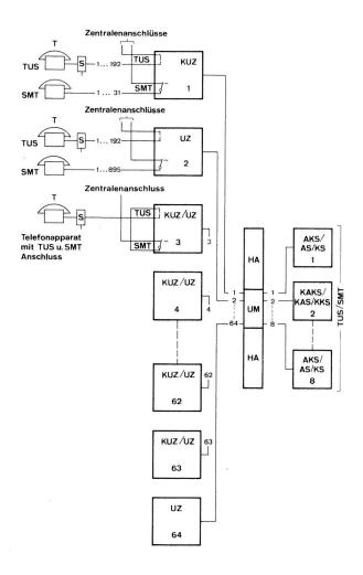
Fig. 11 Kombinierte TUS/SMT-Grossanlage mit Stand-by-Betrieb
