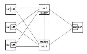
Fig. 12 Grossanlage mit örtlich getrenntem Stand-by-Betrieb
