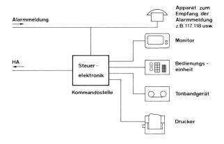
Fig. 9 Kommandostelle mit Peripheriegeräten
