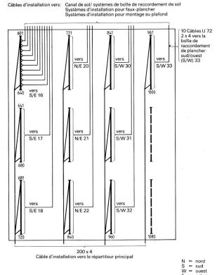
Tous les fils d'installation ou les conducteurs des câbles d'installation doivent être connectés au répartiteur principal ou au répartiteur extérieur (pas de renvois)
