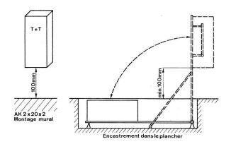
Fig. 19 Hauteur de montage à partir du sol pour appareils de raccordement avec plus de 12 bornes
