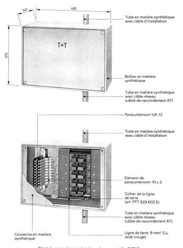
Détail du raccordement de la ligne de terre, voir fig. 3.83.8
