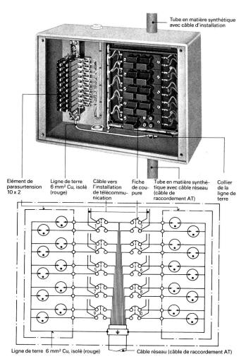
Fig. 24 Armoire de coupure pour introductions de raccordements de télécommunication dans les installations à haute tension TKU 4 kV (boîtier en matière synthétique type  $10 \times 2$ , AP; raccordements, connexions, type  $10 \times 2$ , AP)
