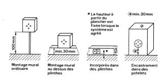
Fig. 18 Hauteur de montage à partir du sol pour appareils de raccordement jusqu'à 12 bornes, inclus les prises de TD-HF
