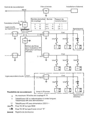
Fig. 20 Raccordement collectif de TD-HF pour grands hôtels et établissements hospitaliers (avec translateur d'entrée, appareils de reproduction avec tension d'alimentation 220 V  $\sim$  )
