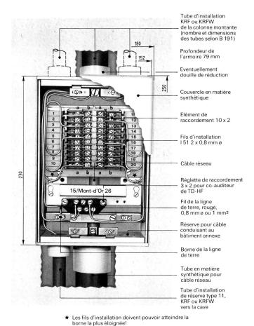
Fig. 6 Armoire de commutation ET 10/20 (raccordement des fils et câbles d'installation, introduction des tubes)
