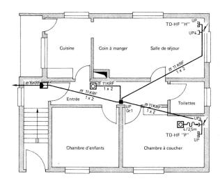
Fig. 11 Installations d'abonnés simples (plan d'installation avec introduction souterraine, installation UP; montage noyé)
