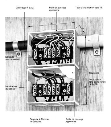
Détail du raccordement des conducteurs de câble et des fils, voir figure 1.84.2
