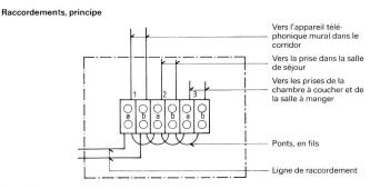
Raccordement des lignes de dérivation dans la boîte de passage au corridor
