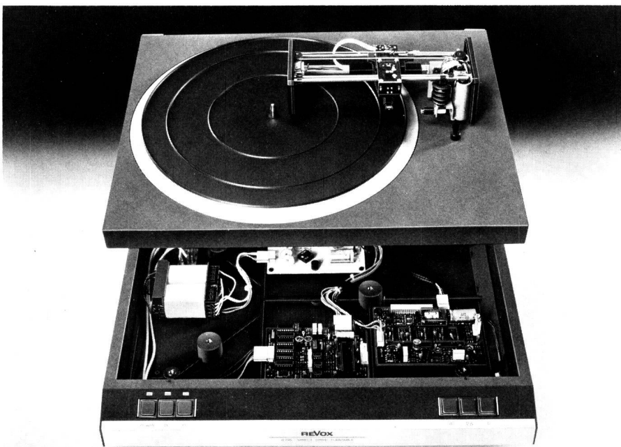
Fig. 3 Das Doppelchassis des Tangential-Plattenspielers B 795 mit festem und «schwimmen- dem» Teilchassis
