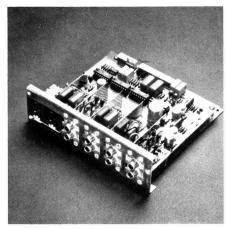
Fig. 2 NF-Anschlusseinheit mit computergesteuerten Analogschaltern. Sorgfältiger Aufbau und spezielle Abschirmungen gewährleisten eine hohe Eingang/Eingang-Übersprechdämpfung für unabhängige Monitor- und Überspielmöglichkeiten
