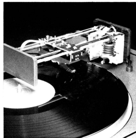
Fig. 4 Schwenkarm bei abgenommener Abdek- kung. Sichtbar ist die Tonarmführung mit hochpräzisem Saitenzug und dem kurzar- migen (40 mm) Leicht-Tonabnehmersys- tem P 20 MDR
