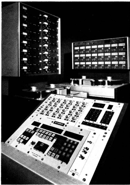
Fig. 6 Steuerpult des Synchronisiersystems TLS 2000 mit zwei professionellen Mehrkanal-Studiotonbandmaschinen A 800 für 16 beziehungsweise 24 Tonspuren
