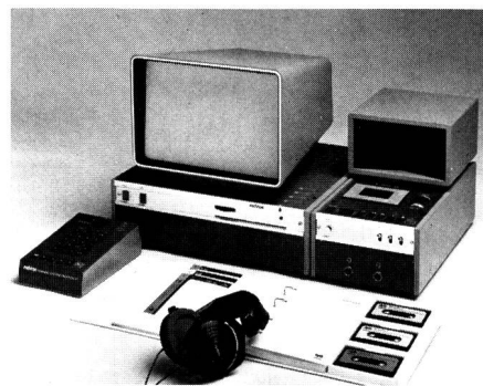
Fig. 5 Arbeitsplatz des Revox-Audiocardsys- tems, bestehend aus Mikrofilmgerät, Kassettengerät und Lautsprecher sowie (vorne links) aus mikroprozessorbesterück- ter Tastatur für die Auswahl beliebiger Bil- der aus dem Mikrofiche und der zugehö- rigen Tonsequenz
