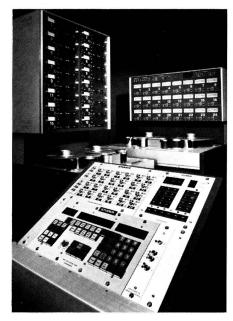
Fig. 6 Steuerpult des Synchronisiersystems TLS 2000 mit zwei professionellen Mehrkanal-Studiotonbandmaschinen A 800 für 16 beziehungsweise 24 Tonspuren
