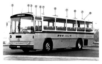
Fig. 14 Einrichtungen für die Be- und Entlüftung des Passagierraumes
