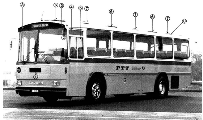
Fig. 14 Einrichtungen für die Be- und Entlüftung des Passagierraumes
