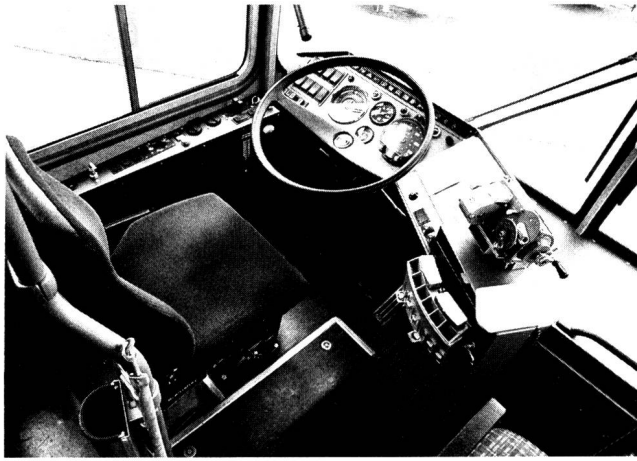
Fig. 8 Arbeitsplatz des Wagenführers
