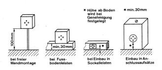
Fig. 18 Montagehöhe ab Boden der Anschlussapparate bis zu 12 Klemmen inklusive HF-TR-Steckdosen
