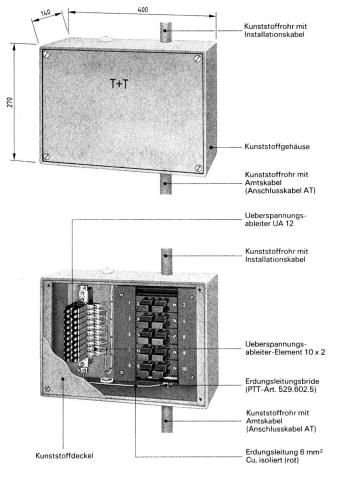
Detail über Anschluss der Erdungsleitung siehe Fig. 3.83.8
