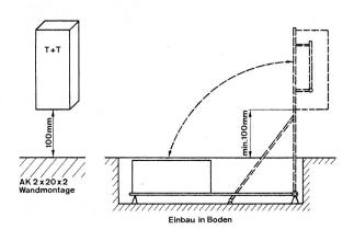
Fig. 19 Montagehöhe ab Boden der Anschlussapparate mit mehr als 12 Klemmen
