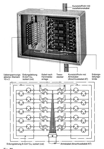
Fig. 24 Trennkasten für Fernmeldeeinführungen in Hochspannungsanlagen, TKU 4 kV (Kunststoffgehäuse Typ  $10\times2$  Aufputz; Anschlussbilder, Schaltung von Typ  $10\times2$  Aufputz)
