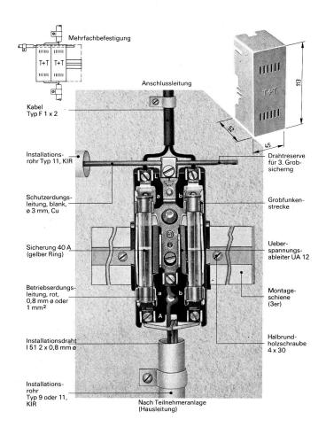
Bemerkung: bei Kabel Typ F = Sicherung 40 A (gelber Ring) bei Kabel Typ P = Sicherung 15 A (violetter Ring)
