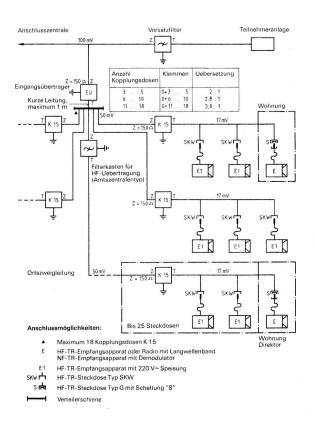
Fig. 20 HF-TR-Sammelanschluss für grosse Hotels und Krankenanstalten (mit Eingangsübertrager, Wiedergabegeräten mit Speisespannung 220 V  $\sim$  )
