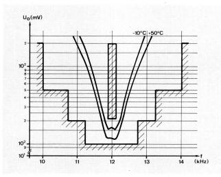
a) Limiti di reazione per 12 kHz: 100...210 mV (regolazione originale)
