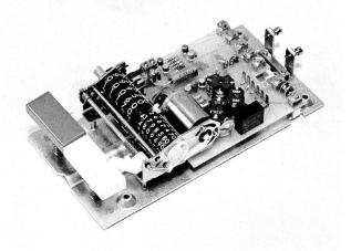
Fig. 3 Indicatore di tassa modello 80, senza il coperchio
