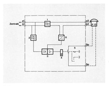
Fig. 4 Schema a blocchi e di connessione dell'indicatore di tassa modello 80
