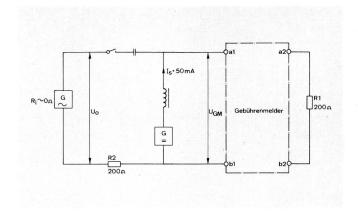
Fig. 7 Schema del dispositivo utilizzato per la misura dei limiti di funzionamento Gebührenmelder — Indicatore di tassa
