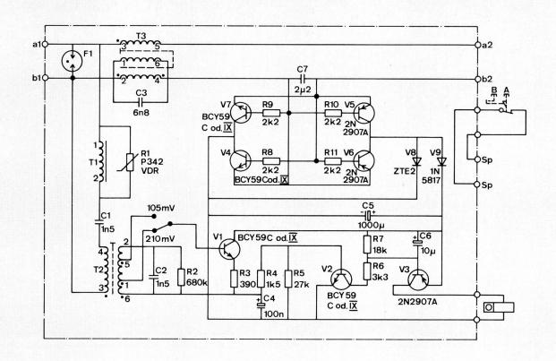
Fig. 5 Schema dell'indicatore di tassa modello 80
