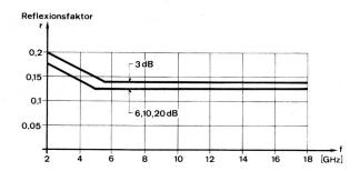
Fig. 12 Reflexionsspezifikation einer grösseren Serie von 3-, 6-, 10- und 20-dB- Abschwächern (Maximalwerte)
