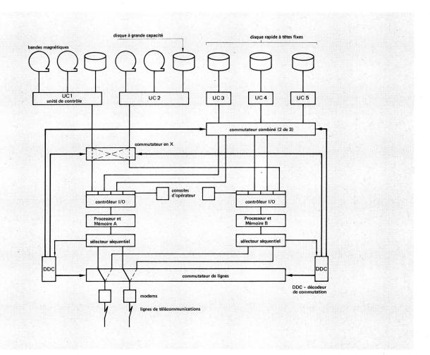
Fig. 20 Configuration redondante adoptée pour une extension du système ATECO
