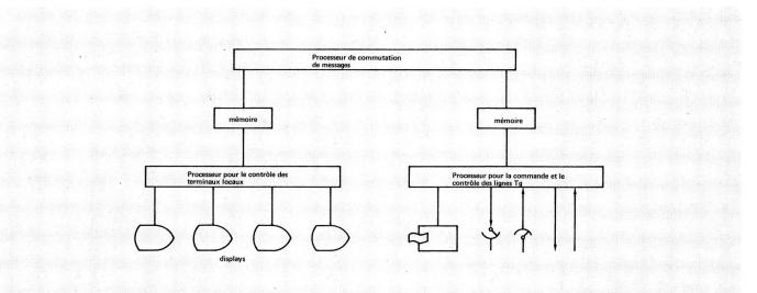
Fig. 13 Configuration à multiprocesseurs
