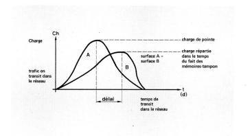
Fig. 23 Effet de la surcharge sur les temps de transit
