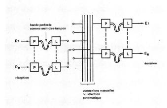
Fig. 4 Centre de commutation semi-automatique
