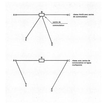
Fig. 2 Réseau avec centre de commutation
