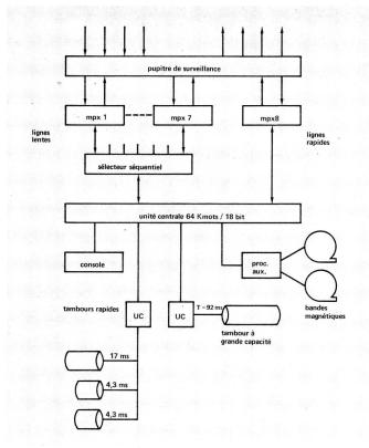
des circuits de transmission, le contrôle des numéros de série sont des tâches qui peuvent être déléguées à des microprocesseurs spécialisés. La figure 13 montre une possibilité de décentralisation. Le système est composé de trois processeurs interconnectés: le processeur principal de traitement associé à deux processeurs de bas de gamme chargés, l'un de la gestion des circuits et, l'autre, de la gestion de terminaux de visualisation locaux.
