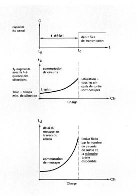
Fig. 22 Comportement de la commutation de circuits et de la transmission de messages en fonction de la charge
