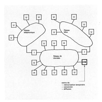
Fig. 26 Situation d'un centre de traitement et de retransmission des messages dans un réseau de données
