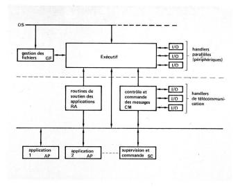
Fig. 16 Exemple de structure d'un logiciel de base
