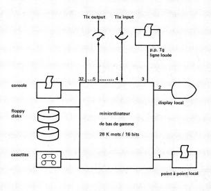
Fig. 12 Système de commutation de messages basé sur un mini-ordinateur
