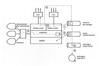
Fig. 15 Flux des messages dans un système de commutation
