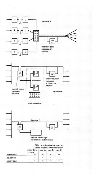
Fig. 5 Equipements électroniques à mémoires magnétiques
