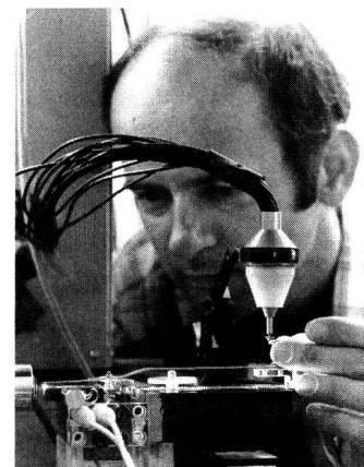
Justierarbeiten an einer temperaturgeregelten Laserhalterung vor dem Abbildungssystem eines Monochromators
