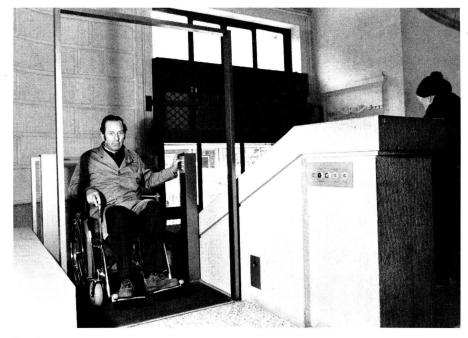
Fig. 2 Obere Haltestelle der Hebebühne
