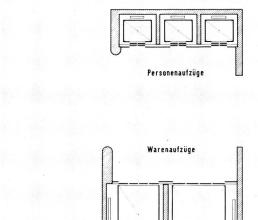
Fig. 1 Disposition der Aufzüge in der Kernzone Ost
