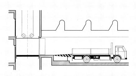
Fig. 6 Warenumschlag über Rampe
