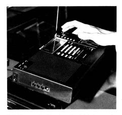
Bei diesem Synthesizer-Portable kann ein Sender mit Suchlauf oder durch Eingabe der gewünschten Frequenz (wie bei einem Taschenrechner) eingetippt und für später auf eine der sechs Speichertasten fixiert werden
