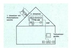
Fig. 3 Blockschaltbild einer Satelliten-Einzelempfangsanlage
