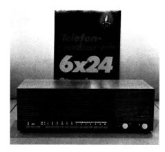
Aus neuer schweizerischer Produktion (Velectra, Biel) stammt dieser kombinierte TR/UKW-Empfänger, der die sechs TR- und 12 UKW-Programme mit programmierbaren Tasten problemlos wählen lässt
