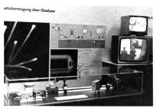
Ein eindrückliches Demonstrationsmodell zeigt die Übertragung eines in der Ausstellung aufgenommenen Farbfernsehbildes über eine Glasfaser auf einen Fernsehempfänger. Dass diese Demonstration echt ist, kann der Besucher durch Unterbrechung des Lichtweges, der auf dem zweiten Monitor zu sehen war, selber bestätigt finden
