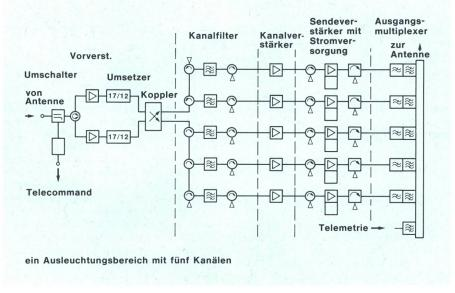
Fig. 1 Nutzlastelektronik des deutschen Rundfunksatelliten TV-SAT D3
