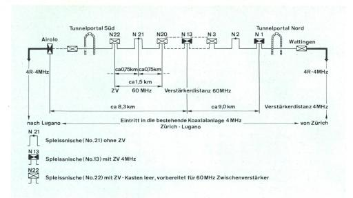
Fig. 2 Prinzipieller Aufbau der Koaxialkabelanlage im Gotthard-Strassentunnel
