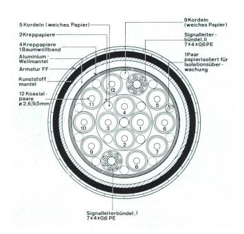
Fig. 1 Querschnitt durch das Koaxialkabel 12 R 2,6/9,5 mm
