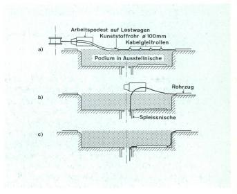
Fig. 10 Einsatzprinzip des Lastwagens mit Arbeitspodest zum Einführen des Kabelendes in die Spleissnische — Impiego dell'autocarro munito di piattaforma per eseguire i lavori d'introduzione della terminazione del cavo nella nicchia di giunzione Arbeitspodest auf Lastwagen — Piattaforma di lavoro su autocarro Kunststoffrohr  $\varnothing$  100 mm — Tubo sintetico  $\varnothing$  100 mm
