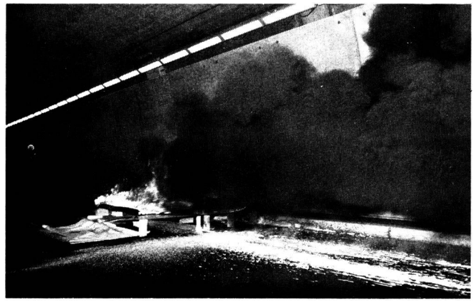
Fig. 5 Brandversuch mit wenig Benzin im Gotthardtunnel: Innert Minuten entsteht ein dichter Qualm, der nur in Bodennähe noch freie Sicht gewährt — Simulation d'incendie par allumage de traces d'essence dans le tunnel du St-Gothard: En quelques minutes, une épaisse fumée empêche toute visibilité sauf à faible distance du sol
