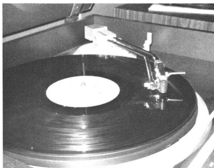
Fig. 19 Dieser Plattenspieler tastet mit einem Infrarotsensor — sichtbar neben dem Tonarm — die Anfänge (Leerrillen) der einzelnen Stücke einer Langspielplatte ab, meldet sie einem Speicher und erlaubt so eine beliebig vorprogrammierbare Reihenfolge
