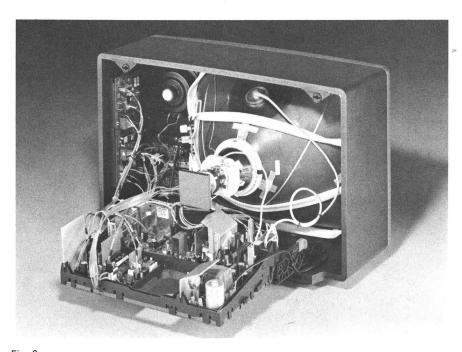
Das aus nur noch zwei Grossmodulen bestehende Profi-Chassis von Loewe-Opta: Speichermodul (links am Gerät) und Universalchassis (herausgeklappt)
