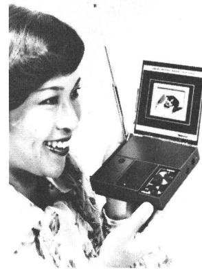
Fig. 21 Mini-Schwarzweiss-Fernsehgerät von Matsushita mit Flüssigkristall-Bildschirm 36 x 48 mm und 57 600 Bildpunkten
