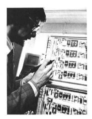
Prüfarbeit an einem System-X-Modul im Forschungszentrum Martlesham Heath des British Post Office — Travail de test à un module du système X de télécommunication au centre de recherches de Martlesham Heath des Postes britanniques
