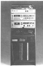
Fig. 14 HiFi-Bausteine normaler Grösse, bestehend (von oben nach unten) aus Plattenspieler, Receiver mit Synthesizerabstimmung und digitaler Anzeige der Frequenz sowie Tape deck (Kassettengerät), zusammengestellt in einem Rack (Foto Telion)
