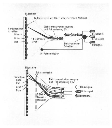
Fig. 23 Vergleich des Strahlprinzips der Einstrahl-Farbbildröhre von National Panasonic (oben) und einer herkömmlichen 3-Strahl-Schattenmaskenröhre (unten)
