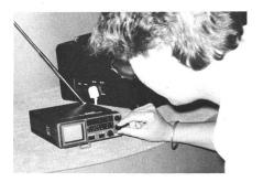
Fig. 22 Mini-Schwarzweiss-Fernsehgerät mit herkömmlicher Elektronenstrahlbildröhre
