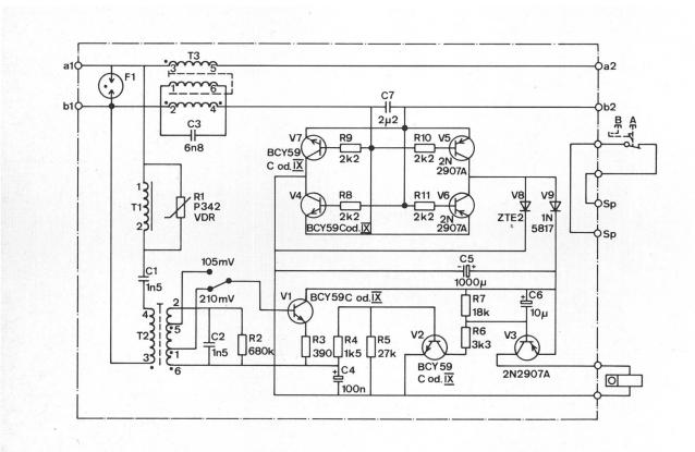
Fig. 5 Schema des Gebührenmelders Modell 80 - Schema de l'indicateur de taxe modèle 80
