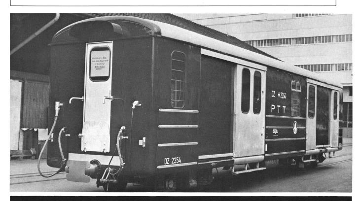
Gepäck-Postwagen Typ DZ der PTT für die Brig—Visp—Zermatt-Bahn. Moderne Schlieren-Schienenfahrzeuge zweckmässiger Konstruktion erleichtern mit ihrem ruhigen Wagenlauf den Dienst des PTT-Bahnpostpersonals.
