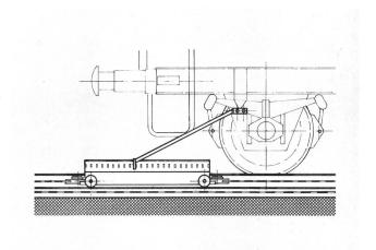
Fig. 3 Prinzipskizze des Schubwagens
