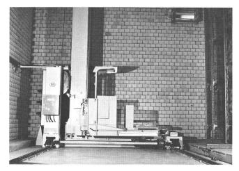
Fig. 13 Querversetzgerät mit Regalstapler
