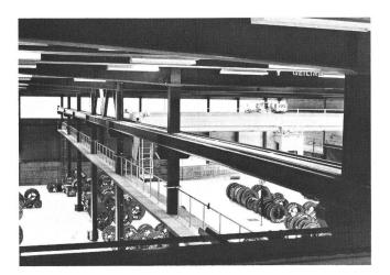
Fig. 5 Laufbahn und Begehungssteg einer Krananlage
