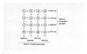
Fig. 2 Signalfrequenzen und ihre Zuordnung zu den 16 Zeichen — Affectation des fréquences de signalisation aux 16 chiffres et symboles du clavier
