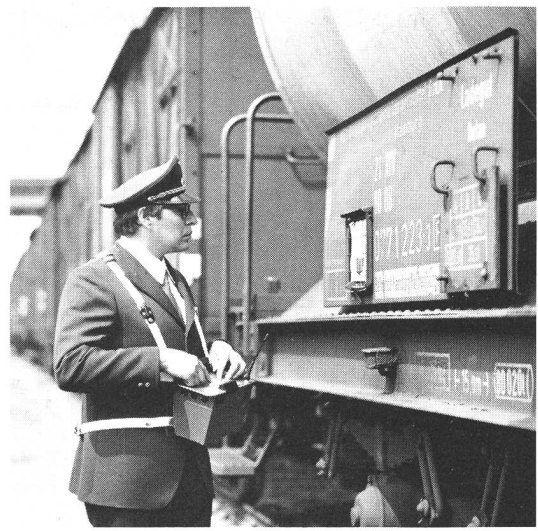
Fig. 3 Teleterminal zum direkten Datenaustausch über Funk mit einer Datenverarbeitungsanlage — Télérterminal pour l'échange direct de données par radio avec une installation de traitement de l'information
