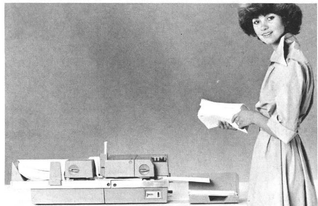
◀ Fig. 3 Der vollelektronische Fernschreiber SP 300, mit seinem Multiprozessorsystem zurzeit wohl der modernste Fernschreiber
