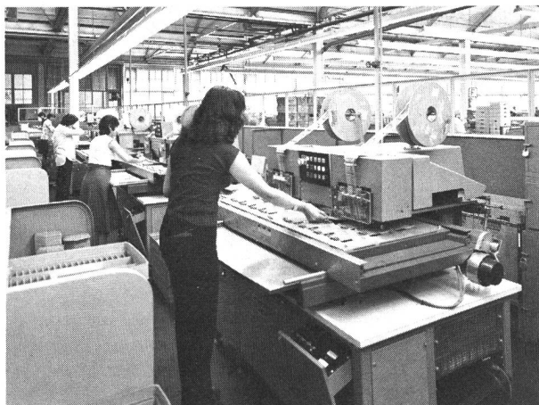
Fig. 1 Teilsicht des Leiterplatten-Bestückungszentrums mit rechnergesteuerten Doppelkopf-Bestückungsmaschinen
