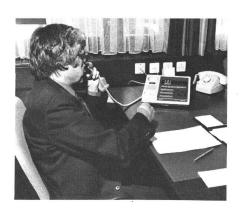
Fig. 1 Vermittlerapparat der Haustelefonzentrale EHZ 8/30
