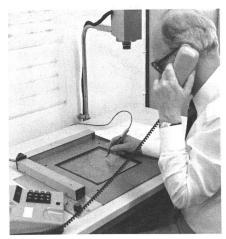
Fig. 4 Standbildübertragung auf einem Telefoniekanal in den Pausen des Gesprächs (Bild-Telefon). Unser Bild zeigt oben die einfache Aufnahmekamera, in Bildmitte die Matrix, auf deren Bild gezeichnet und korrigiert werden kann
