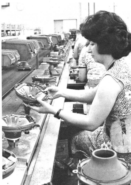
Fig. 2 Fertigungslinie für 30AX-Ablenkspulen. Auf diese Kunststoffträger von hoher Präzision werden anschliessend die Wicklungen aufgebracht
