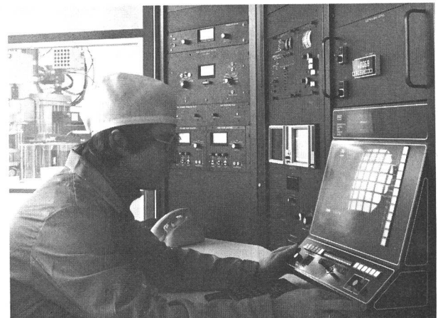
Fig. 5 Zentrale Bedienungskonsolle mit den beiden Rechnern des Elektronenstrahl-Belichtungssystems für Halbleitermasken. Im Hintergrund (durch das Fenster sichtbar) das Zeichengerät
