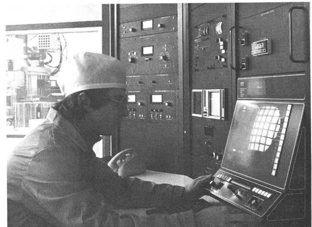
Fig. 5 Zentrale Bedienungskonsole mit den beiden Rechnern des Elektronenstrahl-Belichtungssystems für Halbleitermasken. Im Hintergrund (durch das Fenster sichtbar) das Zeichengerät
