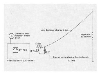
Fig. 9 Schéma du circuit de mesure
