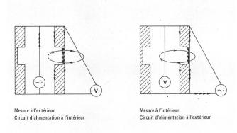
Fig. 1 Interaction électromagnétique entre les conducteurs d'un bâtiment
