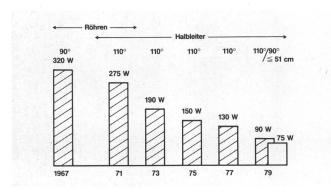
Fig. 5 Leistungsaufnahme der Farbfernsehgeräte (66-cm-Bildröhre)
