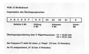
Fig. 8 Übertragungsverfahren der Fernsteuerung
