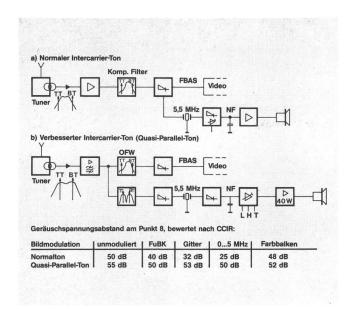
Fig. 3 Blockschaltung des Tonverstärkers
