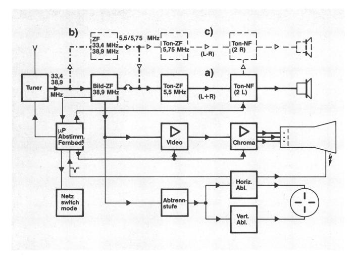
Fig. 1 Blockschaltung eines Fernsehgerätes mit
