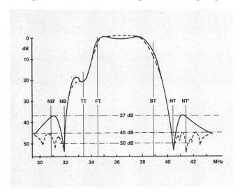
Fig. 2 ZF-Durchlasskurven Diskreter Filter (LC) Oberflächenwellenfilter (OFW)
