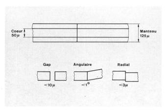
Fig. 12 Tolérance d'alignement des fibres
