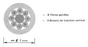
Fig. 5 Câble à fibres toronnées et élément de traction central
