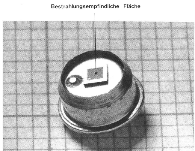
Fig. 36 PIN-Photodiode als optischer Detektor — Photodiode PIN en tant que détecteur de signaux optiques Bestrahlungsempfindliche Fläche — Surface sensible aux rayonnements
