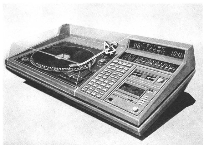
Fig. 1 Eine zukunftsorientierte, in allen wichtigen Funktionen über Infrarotwellen fernsteuerbare 4-Wege-HiFi-Kompaktanlage mit 2x50 W Sinus-Nennleistung und Mikrocomputer für die Steuerung sämtlicher Funktionen
