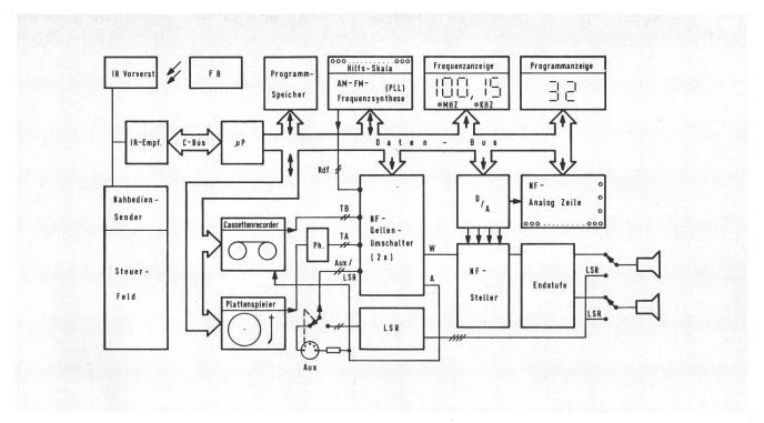
Fig. 2 Blockschaltbild des Kompaktgerätes mit Mikrocomputer
