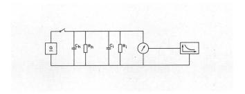
Fig. 6 Détermination expérimentale de C<sub>h</sub>
