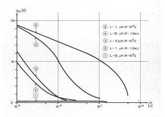
Fig. 9 Tension moyenne de décharge pour l'intervalle  $\Delta t$  (U\_0 = 2 kV)
