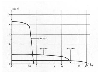
Fig. 8 Valeur de pointe du courant de décharge pour U<sub>o</sub> = 2 kV
