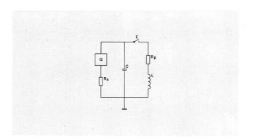
Fig. 3 Décharge du condensateur C à travers  $R_{\text{S}}$  ou  $R_{\text{p}}$  et L
