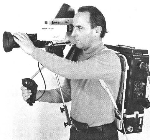
Fig. 2 Tragbare selbständige Kamera. Der Kamerakopf mit der Optik ruht auf der Schulter des Operateurs; das Backpack enthält in seinem oberen Teil die gesamte Elektronik zur Erzeugung eines vollständigen Videosignals, im untern Teil sind die Batterien untergebracht
