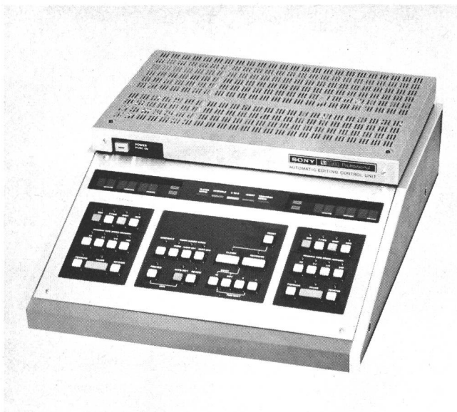
Fig. 11 Ansicht der Vorrichtung eines Montageplatzes zur Steuerung von zwei Videoaufzeichnungsgeräten U-Matic
