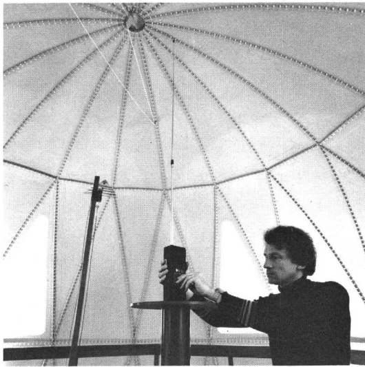
Fig. 4 Aufstellen eines Prüflings auf dem Drehtisch der Plattform, im Hintergrund die verstellbare Messantenne
