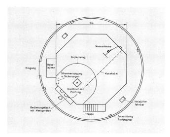
Fig. 3 Anordnung der Einrichtungen im Kugelgebäude
