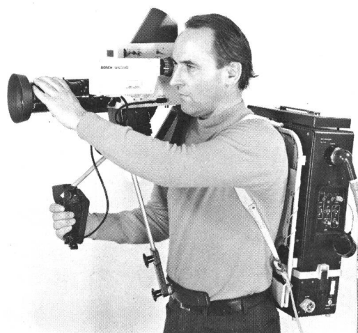
Fig. 2 Caméra portable autonome. La tête de caméra avec son optique se trouve sur l'épaule de l'opérateur; le caisson dorsal contient, dans sa partie supérieure, toute l'électronique nécessaire pour produire un signal vidéo complet. Les batteries sont logées dans la partie inférieure
