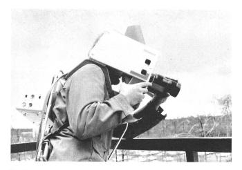
Caméra portable. On distingue la tête de caméra sur l'épaule de l'opérateur et le caisson dorsal contenant l'électronique
