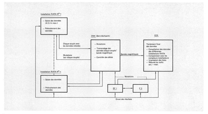
Fig. 1 Structure du système RATA
