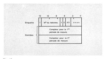
Fig. 13 Cellule pour l'enregistrement des indications relatives à la qualité de service
