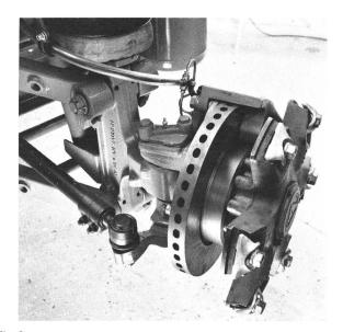
Fig. 2 Vorderachse mit Einzelradaufhängung und Scheibenbremse
