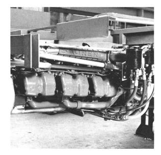
und höchster Drehzahl (Standmessung). Saurer hat eine wesentliche Entwicklungsarbeit geleistet, um den Lärm an der Quelle zu reduzieren. So wurden das Ansaugrohr, das Kurbelwellengehäuse, die Schwungradschüssel und der Ölbehälter steif konstruiert, so dass weniger Schwingungen auftreten und im Endeffekt die Schallabstrahlungsintensität vermindert wird.
