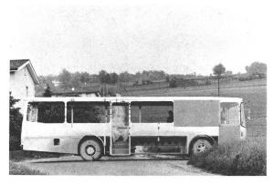
Fig. 6 Rohbaukarosserie mit Dehnungsmessstreifen, bereit zur Messfahrt auf Schlechtwegstrecke
