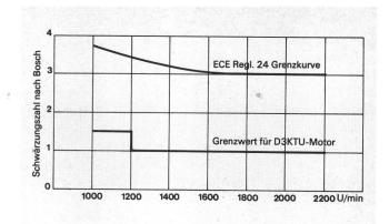
Fig. 10 Vergleich des Vollastrauches des D3KTU-Motors mit der auch in der Schweiz gültigen ECE-Grenzkurve
