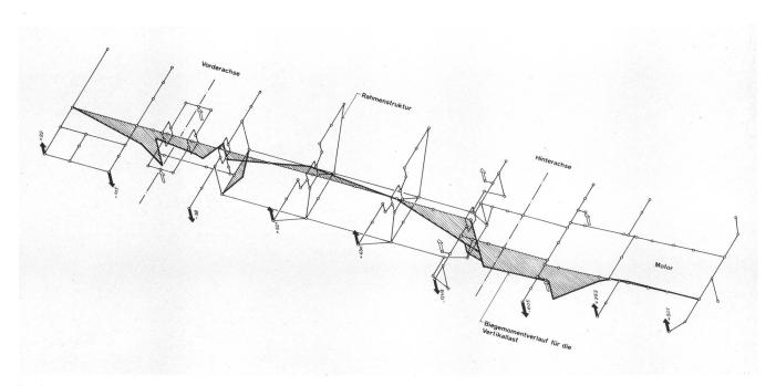
Fig. 5 Auswertung des Nastranprogramms unter Berücksichtigung der Karosseriekonstruktion Hess
