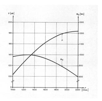
Fig. 12 Leistungskurve des D3KTU-Motors, wie er im Omnibus IV-HU zum Einbau kommt
