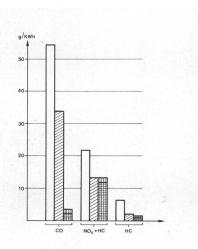
Fig. 11 Vergleich der Abgaswerte des D3KTU-Motors mit den US-Federal-Grenzwerten 1974...1978/79
