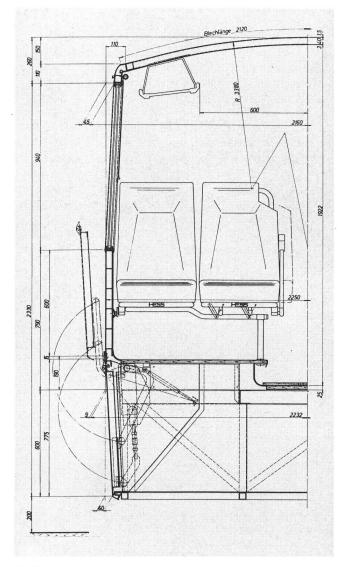
Fig. 16 Querschnitt durch den Karosserieaufbau mit Doppelverglasung, Aussenschwing-Gepäckraumdeckel und 600 mm hohem Seitenwandpro-
