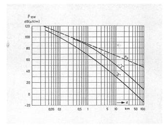
Fig. 7 Affaiblissement de propagation du champ médian  $\overline{F}$  émis avec une puissance de 10 W en fonction de la distance — valable sur le Plateau suisse et dans les vallées alpines soumises à un rayonnement direct
