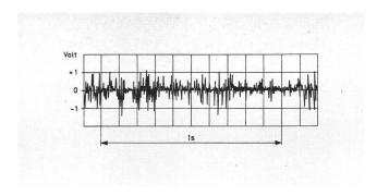
Fig. 10 Impulsions perturbatrices, dues au dispositif d'allumage des automobiles, observées à la sortie basse fréquence d'un récepteur pour la modulation de phase
