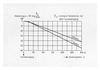
Fig. 8 Affaiblissement moyen du champ à l'entrée d'un tunnel; décroissance du champ en fonction de la pénétration pour les fréquences de 90 à 170 MHz
