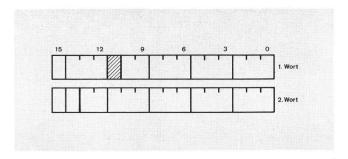
Fig. 8 Jedem in der internationalen Zentrale in Betrieb stehenden Übertrager zugeordnete 2-Wort-Speicherzelle
