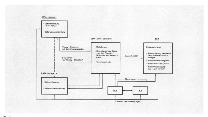
Fig. 1 Struktur des RATA-Systems
