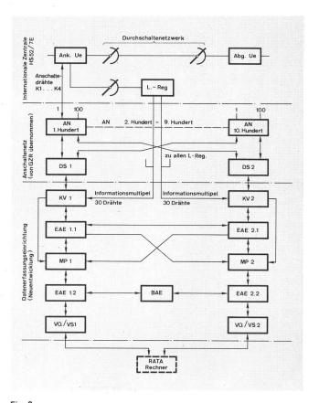
Fig. 3 Aufbau der Datenerfassungseinrichtung Autophon Ank. Ue Ankommender Übertrager (überwachte Einheit)
