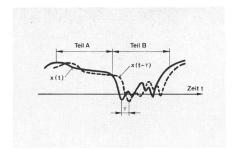
Fig. 2 Kurve zur Erklärung der Korrelationsfunktion
