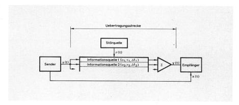
Fig. 1 Ersatzbild eines Ortungssystems
